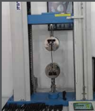
PRUEBA DE TENSIÓN
